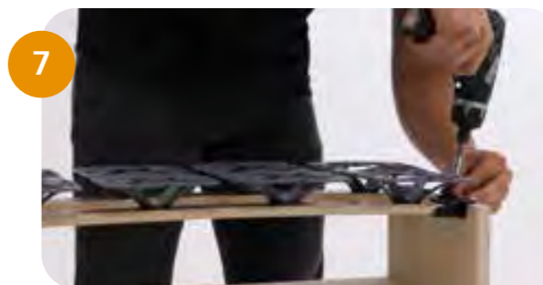
Leistenaufnahmen im gleichmäßigen Abstand am Rahmen festschrauben. | Screw the slat holders evenly spaced to the frame.
