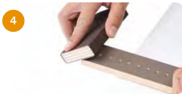
Wir empfehlen, die Kanten sauber abzuschleifen. | We recommend sanding the edges clean.
